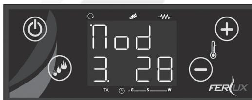
La hydro-estufa detecta que el calor generado no puede intercambiarlo por completo, por lo que entra en estado de modulación para garantizar el intercambio máximo, el máximo rendimiento y un ahorro de combustible.
