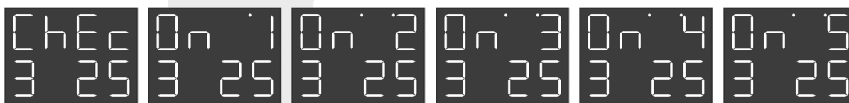
CHEQUEO PRE-CALENTAMIENTO PRECARGA ENCENDIDO FIJO ENCENDIDO VARIABLE ESTABILIZACIÓN
